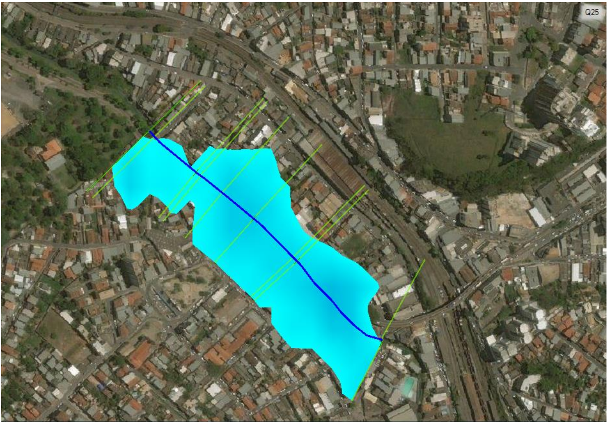
Figura 24 Mapa de Inundação para Q_{max} com período de retorno de 25 anos (adaptado HEC-RAS).
