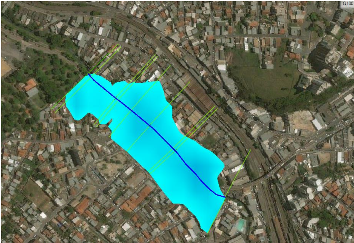
Figura 26 Mapa de Inundação para Q_{max} com período de retorno de 100 anos (adaptado HEC-RAS).
